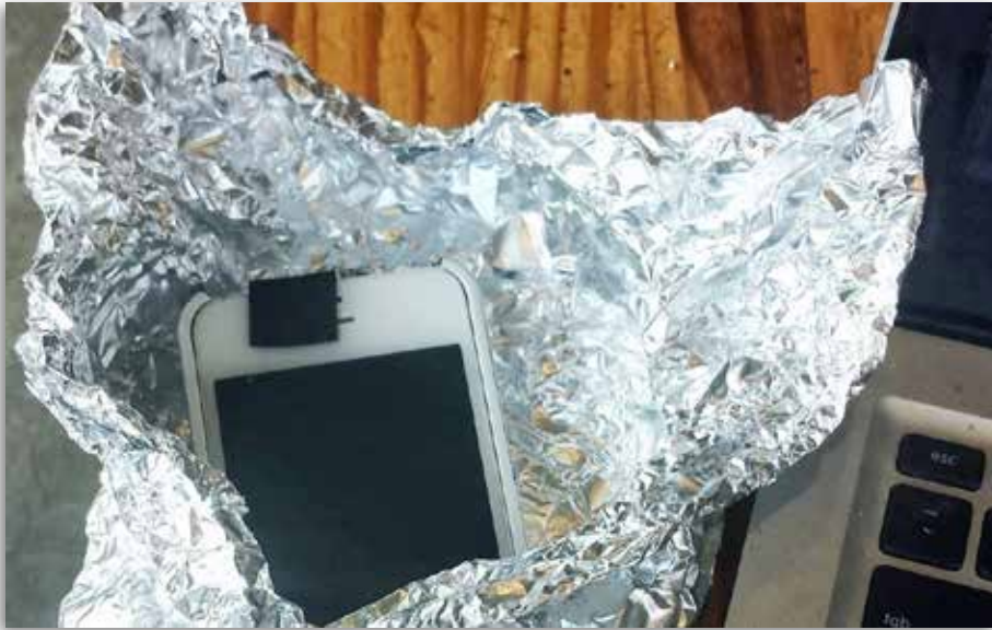
A fólia egy Faraday kalitkát képez, amin a mikrohullámok sem tudnak áthatolni, ezért a mobiltelefon nem lesz elérhető
